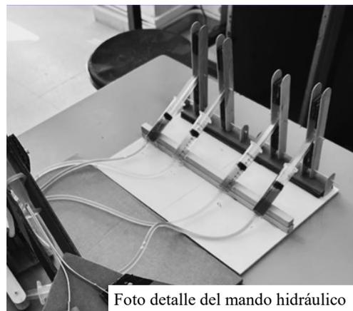
Foto detalle del mando hidráulico
